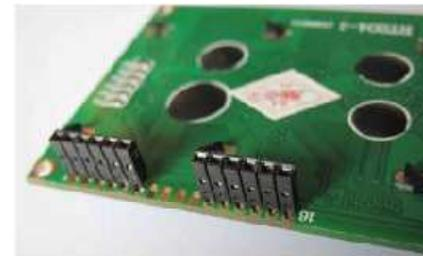
Photo 7 : Les 2 connecteurs femelles 6 broches soudés sous l'afficheur
