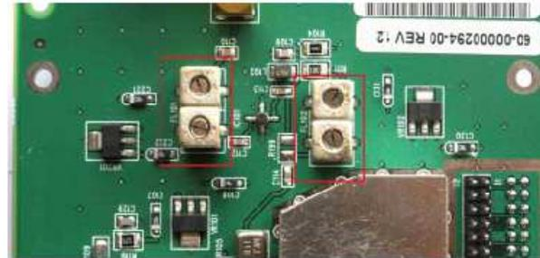
Photo 6 : Filtrés hélicoïdaux du circuit d'entrée FL101 et FL102
