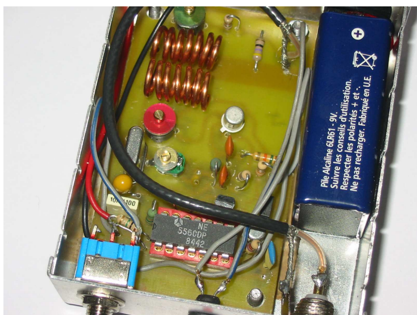
Photo 2 : « oscillateur parallèle ». L'inductance L1 a été remplacée par un condensateur variable, la résistance R6 derrière le quartz a été supprimée, et le condensateur C5 a été enlevé et shunté sous le circuit imprimé.
