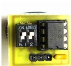
Photo 3 : Le module additionnel enfilé sur le connecteur à 3 broches
