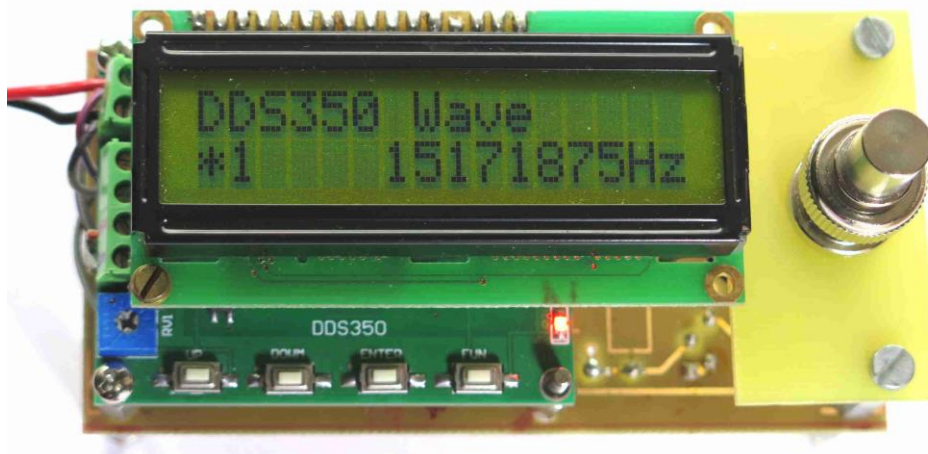
Photo 1 : Balise VHF [120 MHz – 150 MHz] vue côté DDS et sortie BNC. La puissance est ajustable par résistance. La fréquence affichée 15,171875 MHz est multipliée par 8 pour obtenir l'émission sur 121,375 MHz
