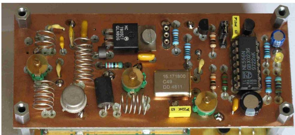
*Photo 1 : La carte de l'émetteur 121,375 MHz montée avec la balise 406.
