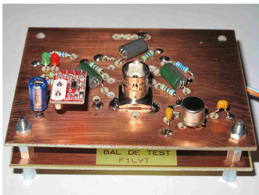
Photo 1 : Balise 406 de test, sortant une puissance du mW, dont la fréquence est modifiable par changement d'un quartz
