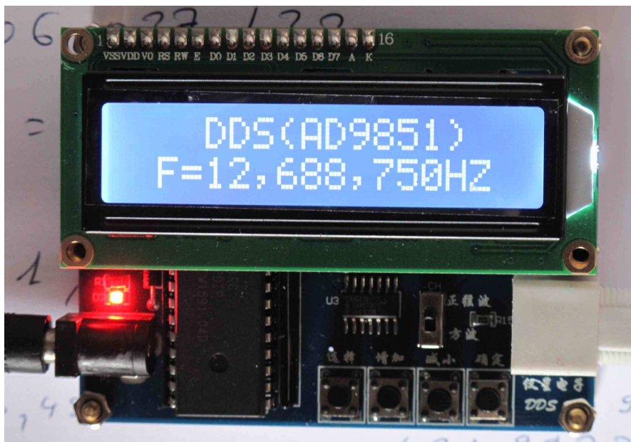
Photo 5 : Générateur DDS réglé sur 12,688,750 Hz, soit 12,688.750 MHz
