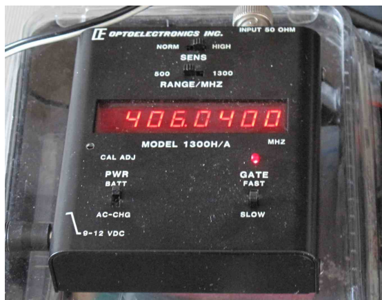
Photo 7 : Mesure au fréquencemètre de la fréquence UHF obtenue
