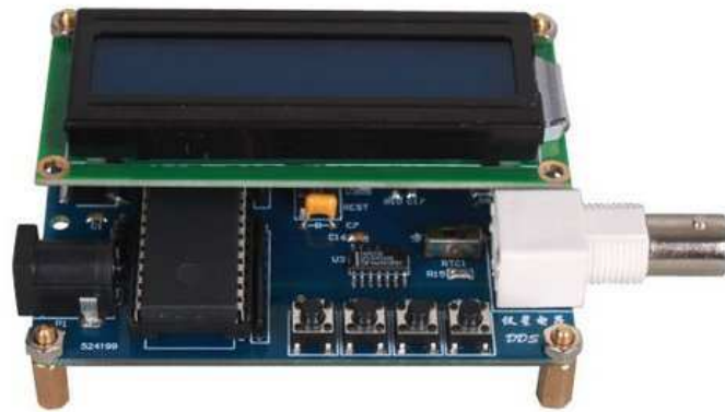
Photo 4 : Générateur DDS utilisant le circuit synthétiseur AD9851
