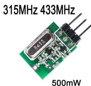
Photo 1 : Module 433 MHz avec une puissance de 500 mW
