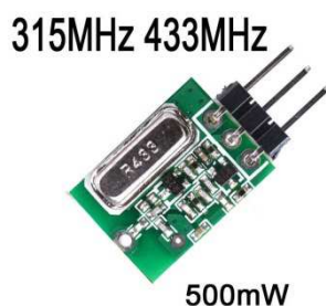
Photo 1 : Module 433 MHz avec une puissance de 500 mW
