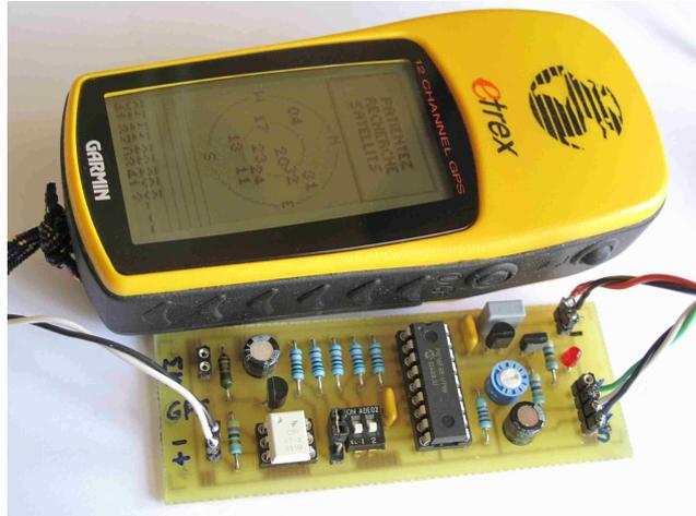
Photo 5 : Générateur de trames recevant l'information de position d'un Garmin Etrex
