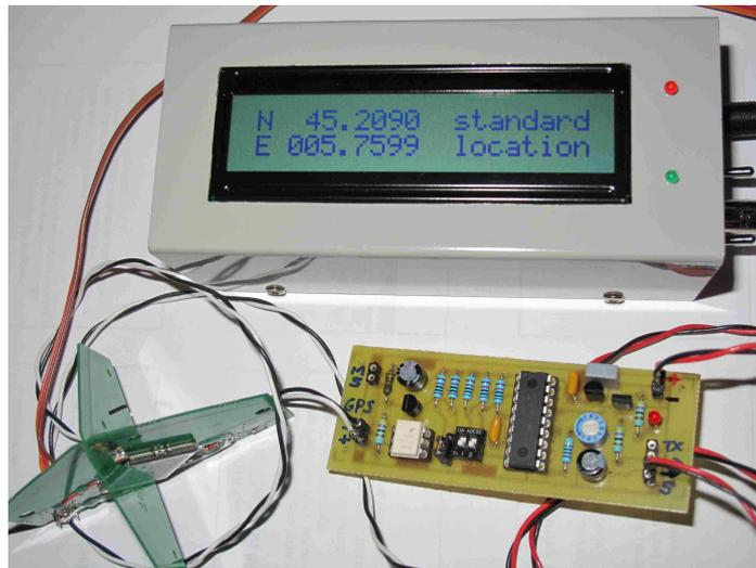
Photo 8 : La position reçue par le GPS est intégrée dans la trame ; elle apparaît sur l'affichage du décodeur.
