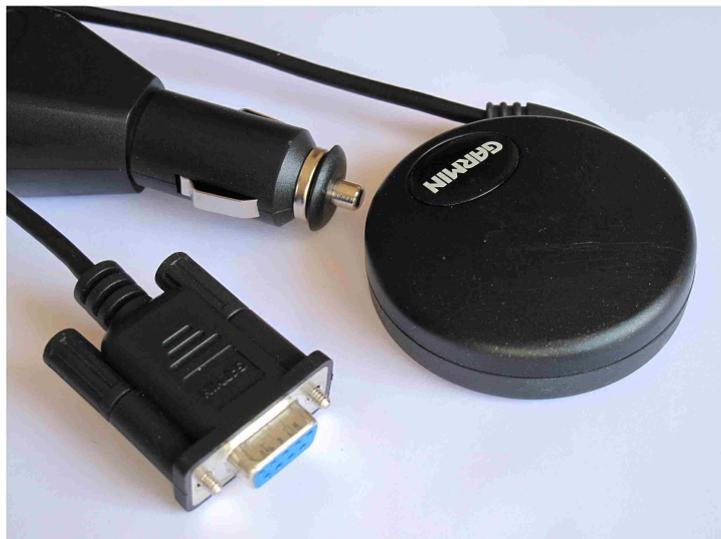
Photo 6 : GPS Garmin 18 PC. La sortie est faite sur une prise DB9.
