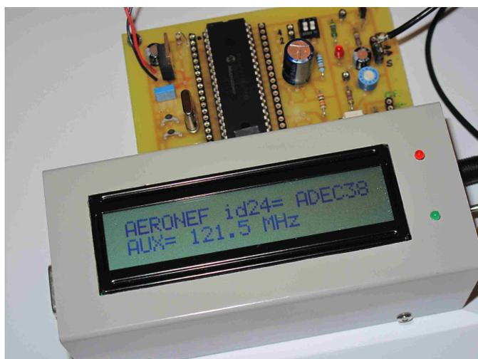
Photos 4 : On peut lire l'identifiant en hexadécimal « ADEC38 » (6 chiffres entre 0 et F)
