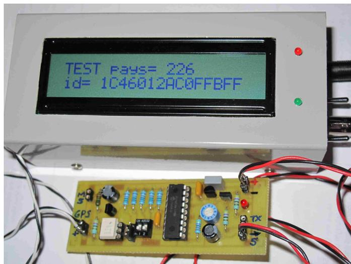
Photo 3 : Décodage d'une trame avec un décodeur de type F6HCC
