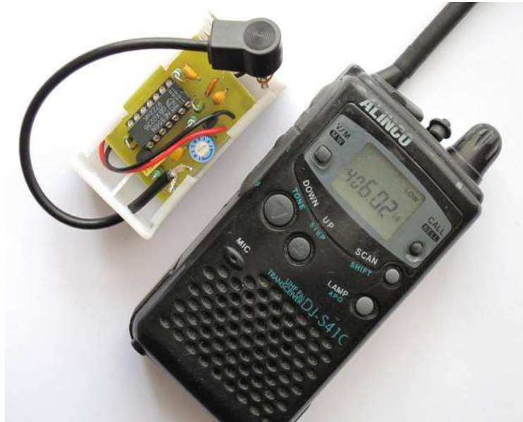
Photo 2 : Emetteur calé sur une fréquence COSPAS SARSAT
