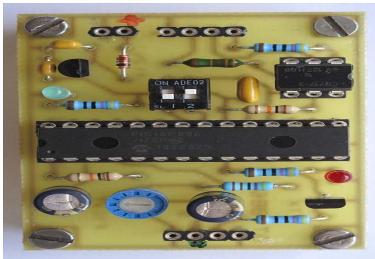
Photo 1 : Générateur de trames réalisé avec un PIC 16F886
