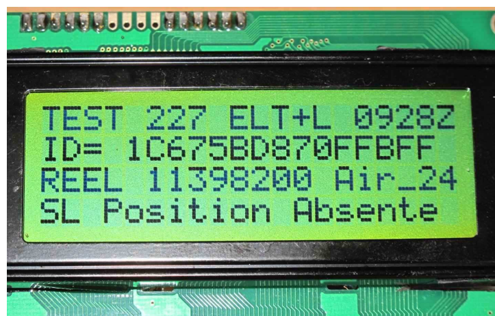
Photo n°5 : Trame transmise par une balise qui devrait donner sa position, mais le GPS de la balise ne fonctionne pas. L'heure de la réception est affichée.
