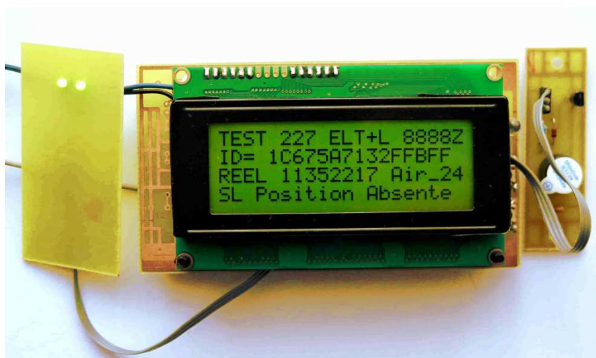
Photo 1 : Le décodeur de trames en fonctionnement.
