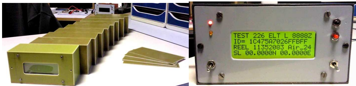
Photo 2 : Construction d'une série de décodeurs de trames avec le circuit imprimé « Version 1 »
