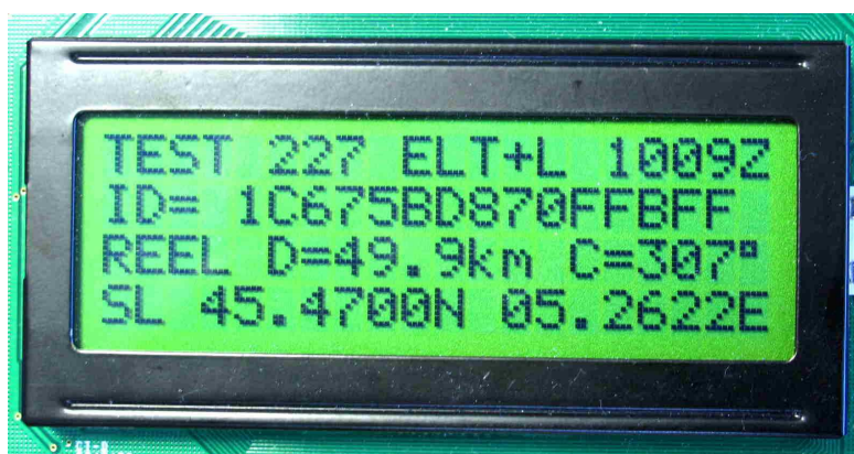
Photo 1 : Affichage de la distance et du cap. La balise est à 49,9 km, au cap 307°.
