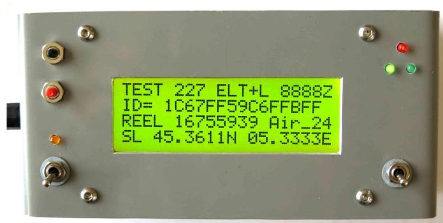
Photo 3 : **Trame de balise d'avion** (ELT) en cours de test : TEST en début de 1<sup>ère</sup> ligne
