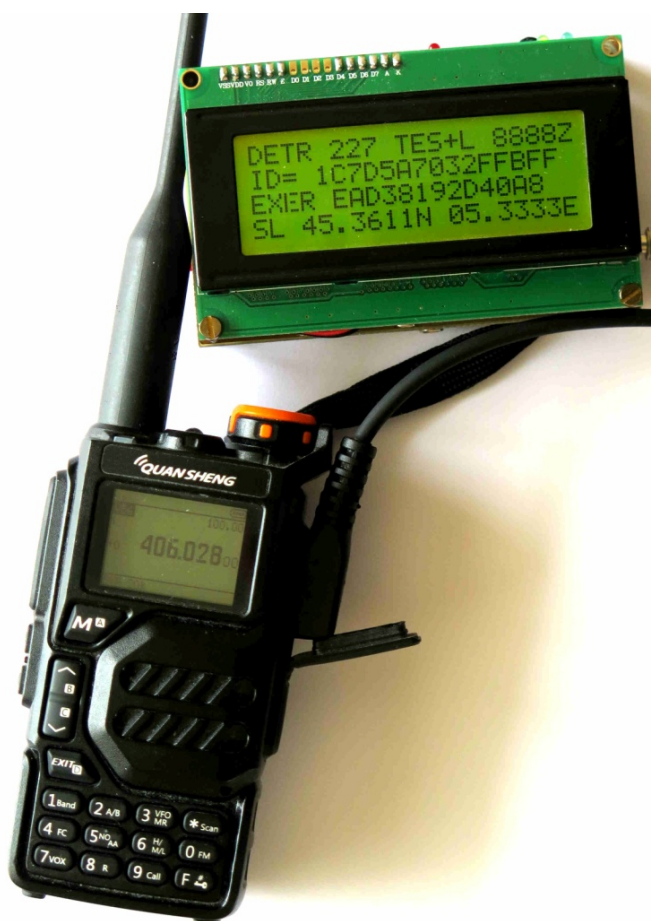
Photo 1 : Décodage d'une balise 406 MHz avec un récepteur UV-K5 en version « IJV 3.60 »
