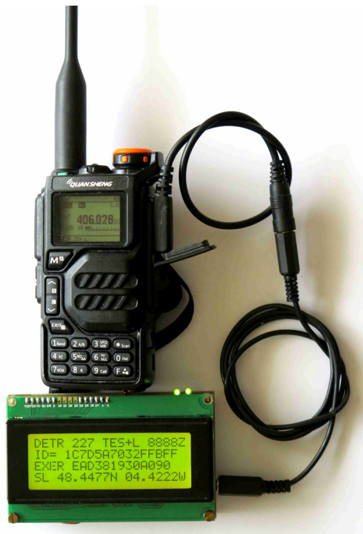
Photo 1 : L'association d'un UV-K5 avec un décodeur DECTRA 4 lignes donne un système de décodage autonome, compact et efficace
