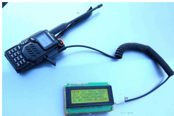
Photo 5 : Décodage d'une balise 406 lors d'un exercice SATER
