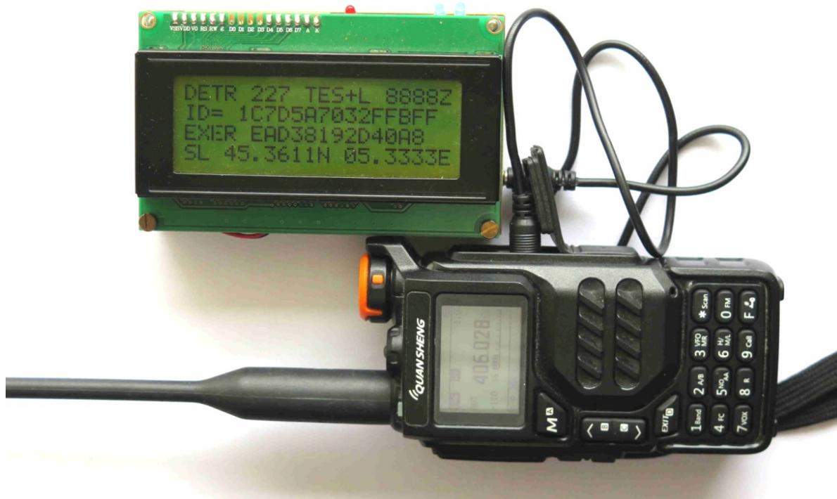
*Photo 5 : Fonctionnement de l'ensemble « Quansheng UV-K5 + décodeur »*
