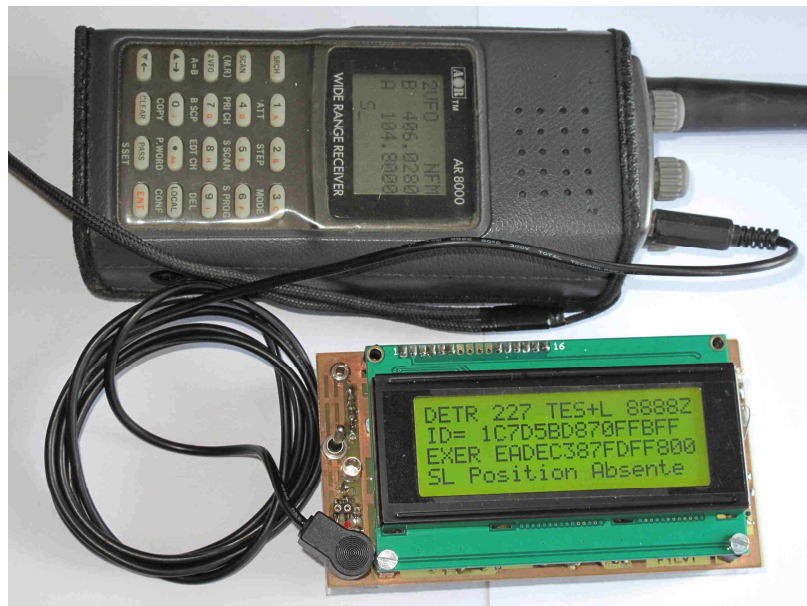
Photo 1 : Système autonome de réception et décodage des trames des balises 406
