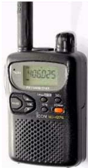
Photo 8 : Le récepteur IC-Q7 lors des tests. Comme le récepteur est au pas de 5kHz, il est calé sur 406,025 ou 406,030 pour une balise sur 406,028 MHz
