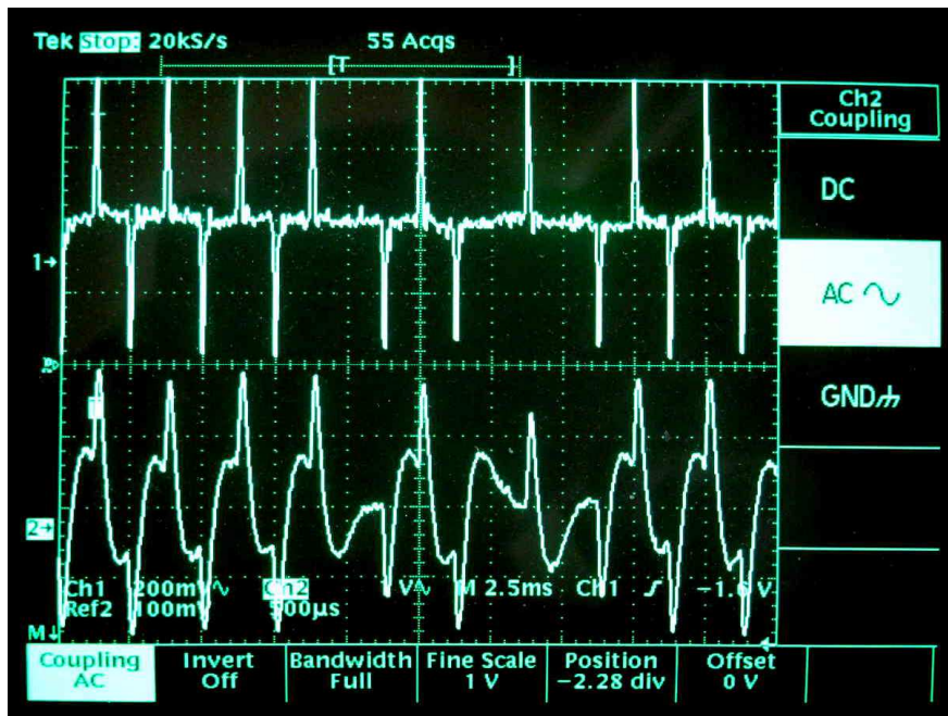
Photo 3 : Visualisation à l'oscilloscope des signaux (AOR AR 8000) : En haut : Sortie « discriminateur » (400 mV crête). En bas : Les signaux sur la sortie audio (prise écouteur) (1,4 à 2V crête)
