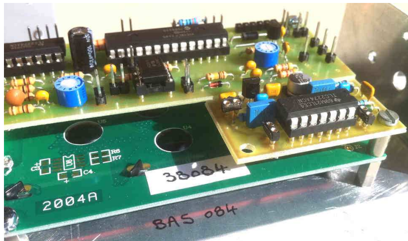
Photo 2 : Module « DérivAudio » installé dans un décodeur DECTRA en cours de montage. Comme le circuit imprimé du décodeur n'occupe qu'une partie du dos de l'afficheur, la place est suffisante pour mettre le module « DérivAudio » à côté (Photo : F1AVR - ADRASEC 38).
