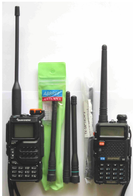
Photo 4 : De gauche à droite : (1) le Quansheng UV-K5, (2) l'antenne télescopique Abbree AR-775 dans son étui, (3 et 4) les 2 antennes de remplacement Baofeng TX-5R et l'Abbree télescopique, (5) l'antenne Baofeng TX-5R, (6) le Baofeng l'UV-5R
