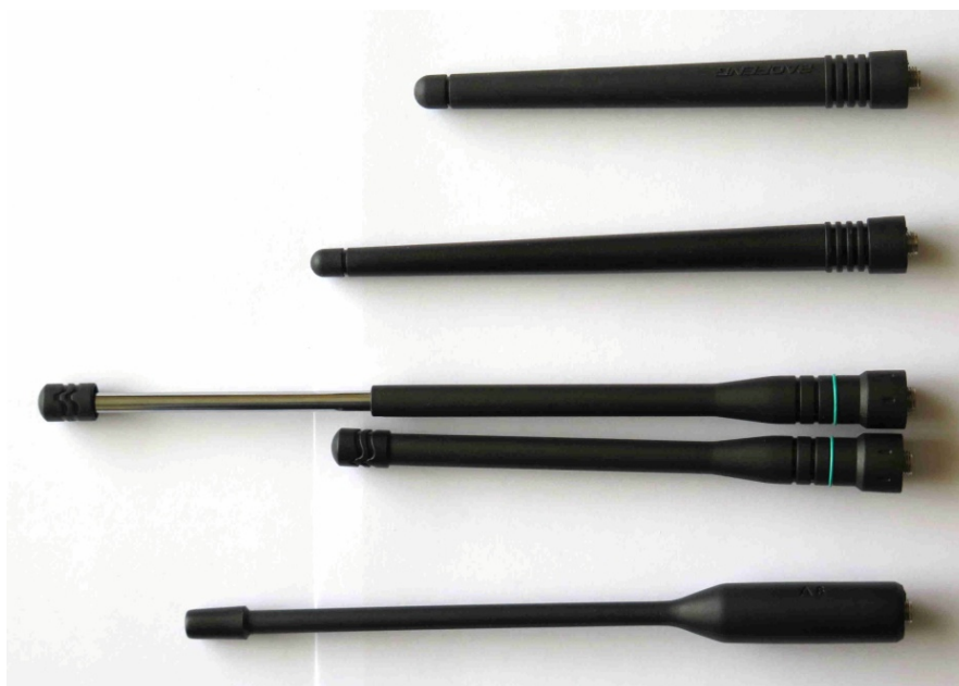
Photo 3 : Les antennes testées. De Haut en bas : (1) Baofeng UV-5R d'origine, 12 cm, (2) Baofeng de remplacement 14,5 cm, (3 et 3 bis) ABBREE AR-775 télescopique, 14 cm repliée et 48 cm dépliée, (4) Quansheng UV-5R d'origine, 18 cm.
