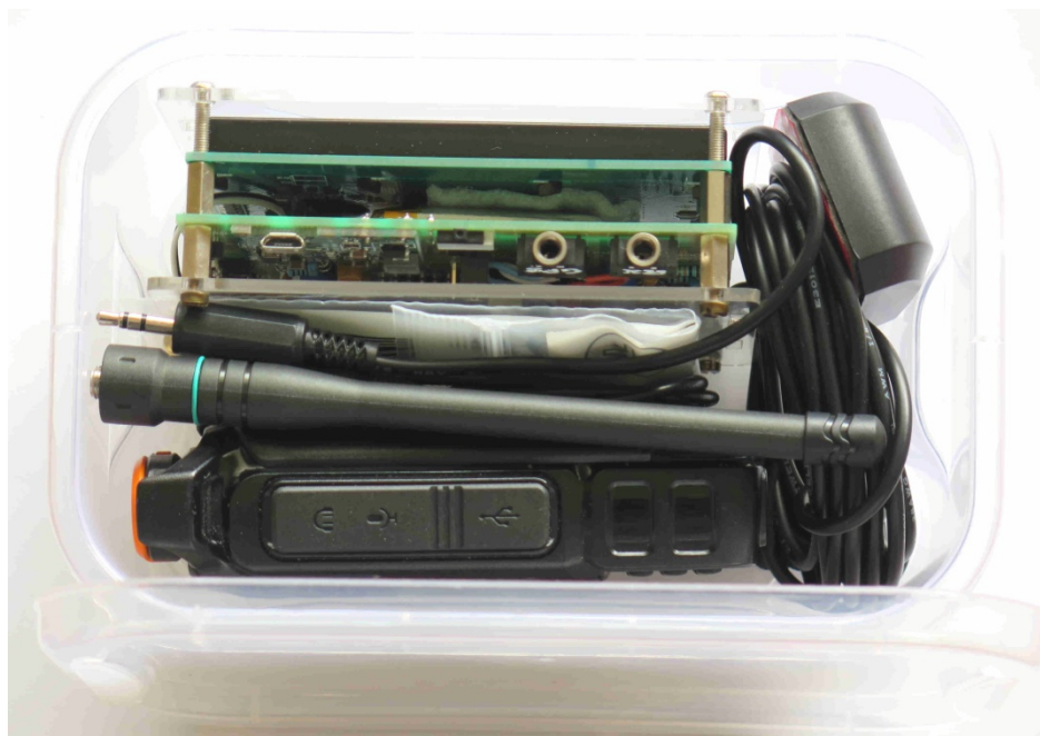
Photo 2 : L'ensemble « Récepteur UV-K5 – Décodeur DECTRA – GPS – cordons » rentre parfaitement à l'intérieur du coffret
