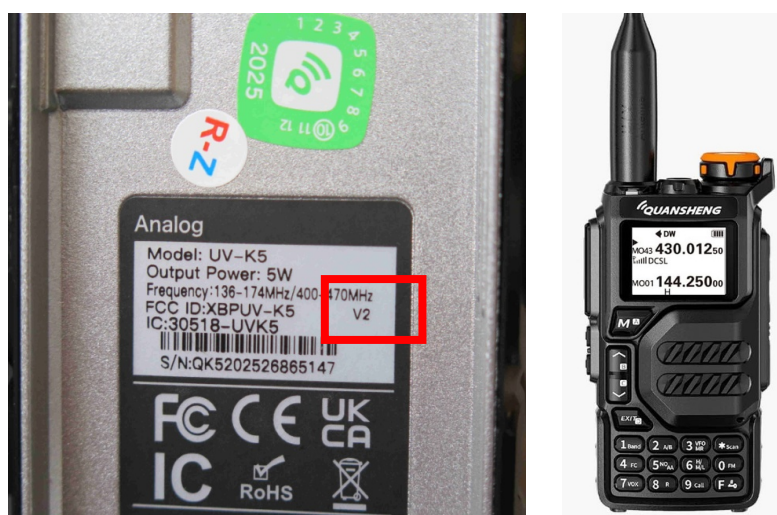
Photo 1 : Face arrière d'un UV-K5 fabriqué en octobre 2025 (voir l'étiquette verte). Au bout de la ligne « FCC ID :XBPUV-K5 », on lit clairement l'indication « V2 ».
