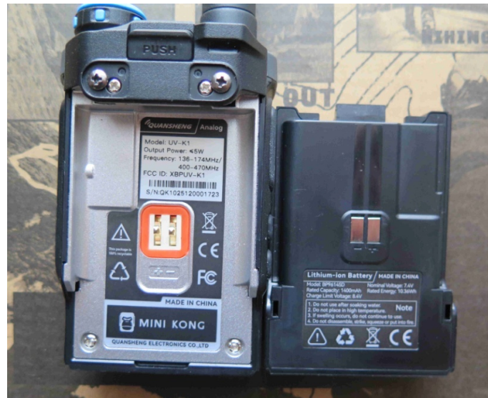
Photo 3 : L'UV-K1 ouvert, avec sa batterie courte de 1,4 Ah
