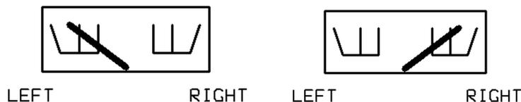
Figure 5 : Déviation du galvanomètre à gauche ou droite (doc L-Per)
