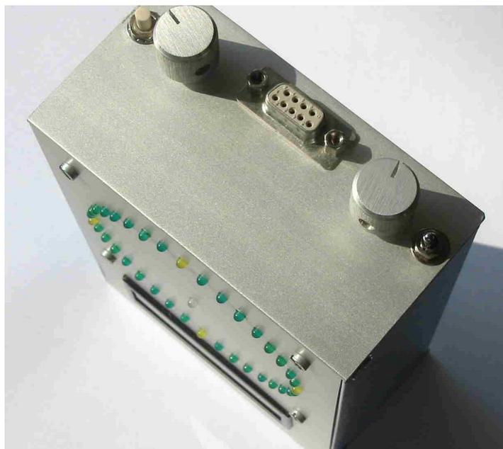
Photo 9 : Boîtier Doppler avec le connecteur DB9 pour envoyer les signaux de commutation vers l'antenne.
