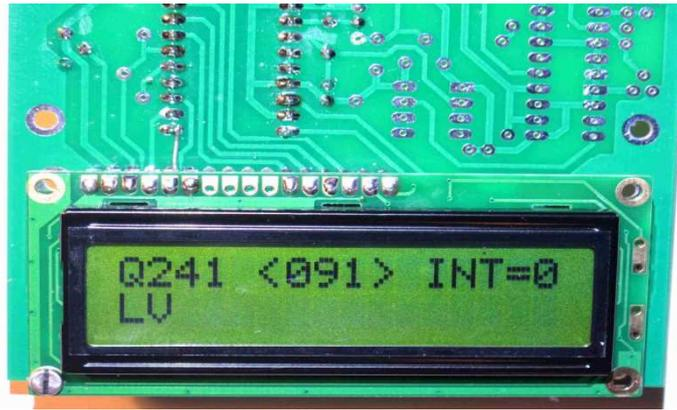
*Photo 5 : Avec le PIC sur son support, on voit le fonctionnement de l'afficheur. On voit aussi la queue de résistance soudée entre la pin 21 du support du PIC et la pin 5 du connecteur de l'afficheur pour remplacer la piste manquante.*
