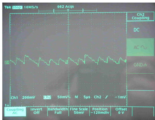
Photo 3 : Ondulation de la tension de sortie (5V) pour un débit de 10 mA (Charge : 470 \Omega // 100 pF)
