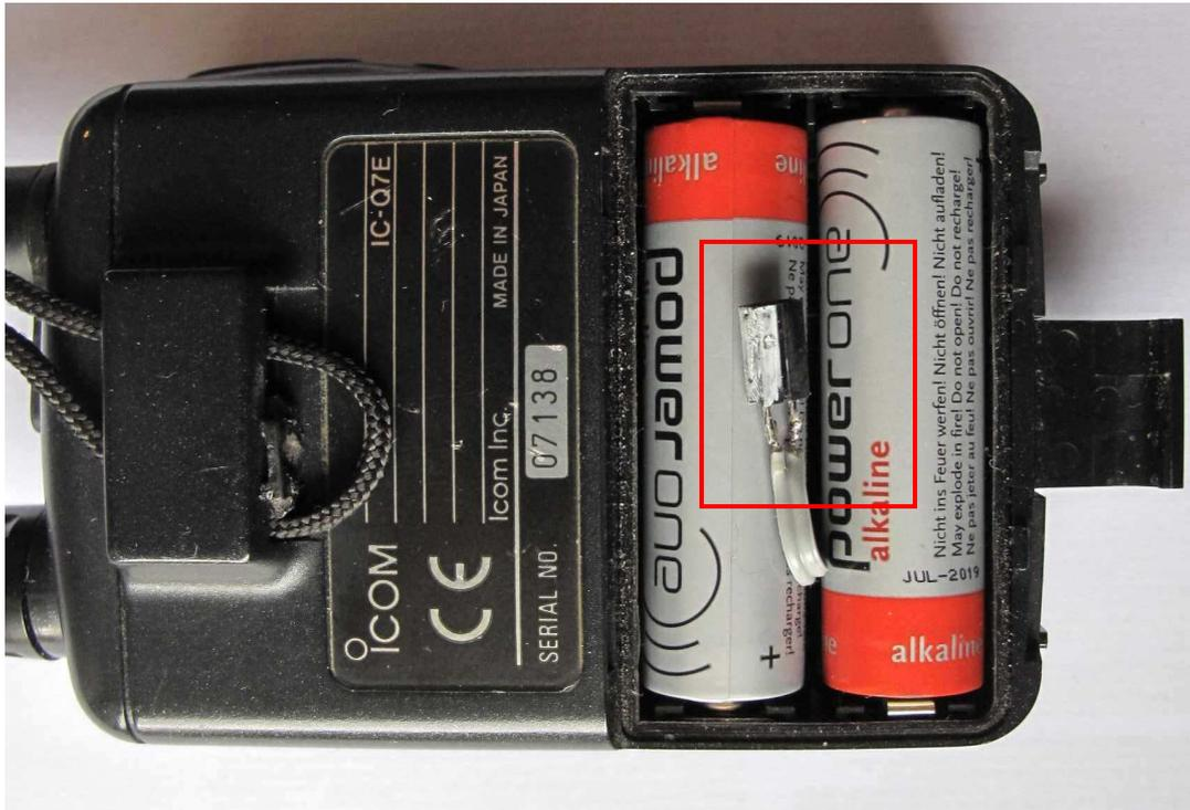
*Photo 6 : Les fils sortent entre les 2 piles qui sont séparées par un intervalle de 1 mm. Le connecteur est replié entre les piles. Le faible encombrement du connecteur permet de remettre sans problème le couvercle du compartiment piles.*
