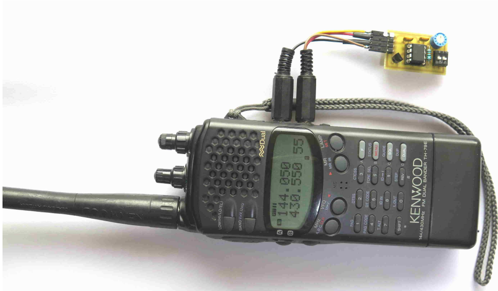
Photo 4 : « Génépious » transformant un TX portable Kenwood TH79 en balise
