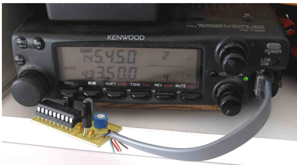
Photo 3 : Générateur d'indicatif monté sur un Kenwood TM-732
