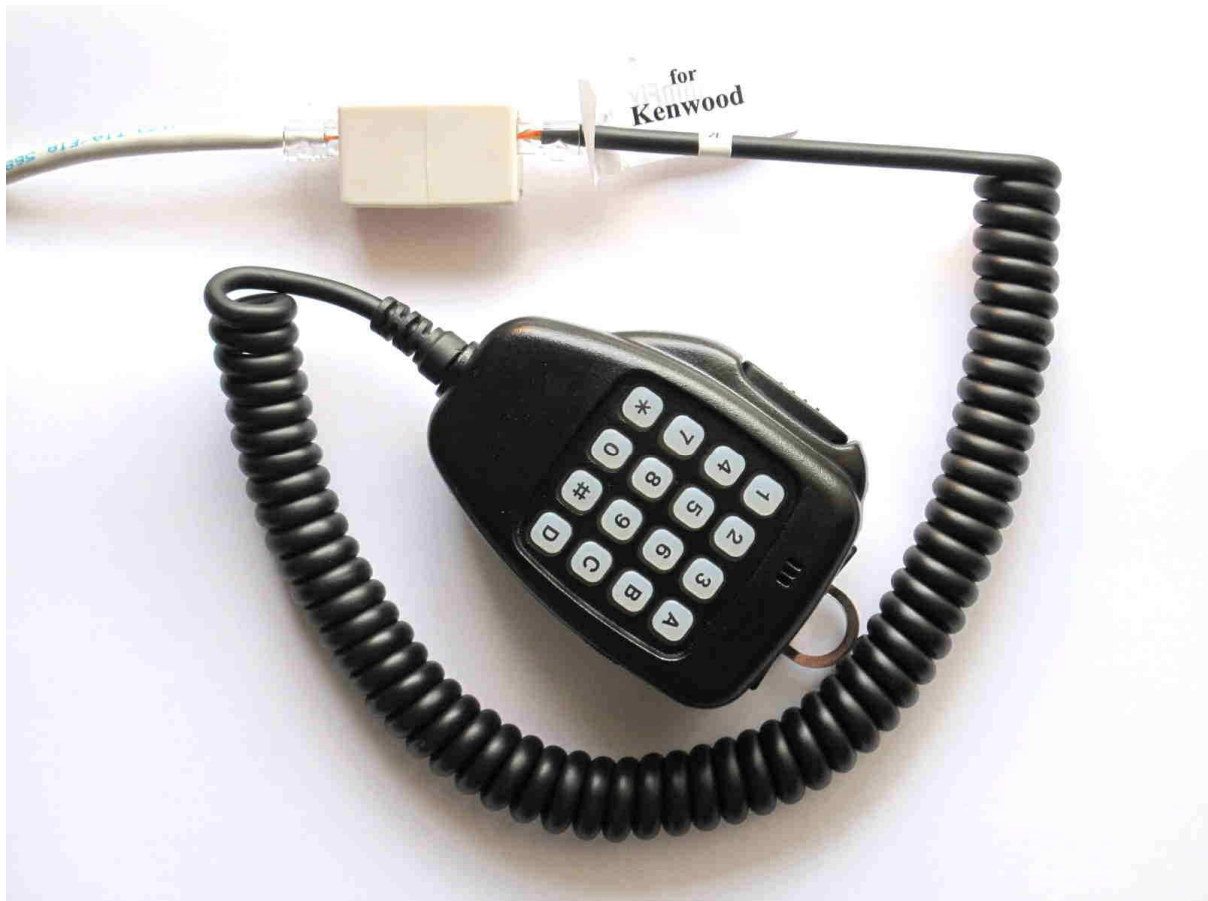
Photo 4 : Le micro Technofix avec son adaptateur RJ45 modifié
