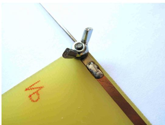
*Photo 3 : L'articulation des brins et la fixation par écrous à oreilles*
