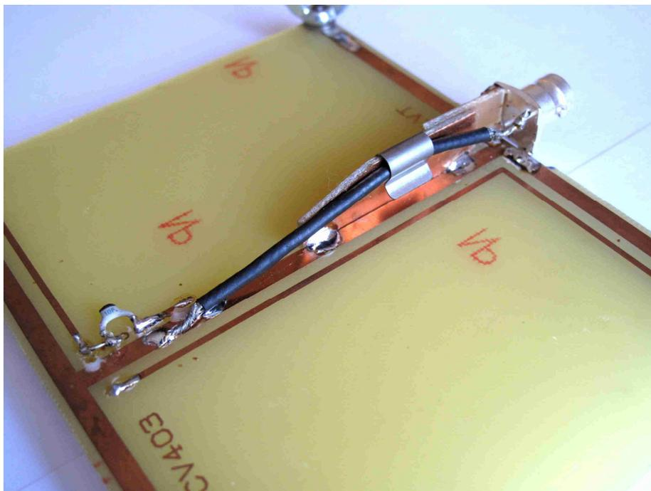
*Photo 4 : La nervure centrale de l'antenne permet de fixer solidement l'embase BNC, et de maintenir le câble de liaison vers le point d'alimentation.*
