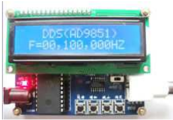
Photo 4 : Générateur DDS construit autour du circuit AD9851, fonctionnant jusqu'à 50 MHz, disponible sur Ebay
