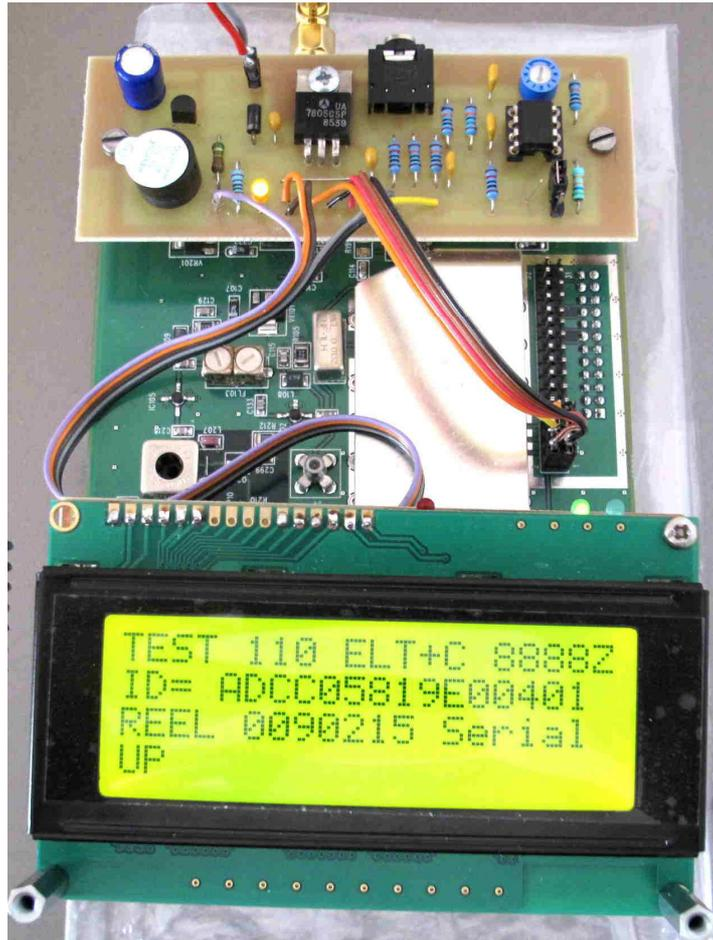
*Photo 8 : Le récepteur associé au décodeur en fonctionnement*
