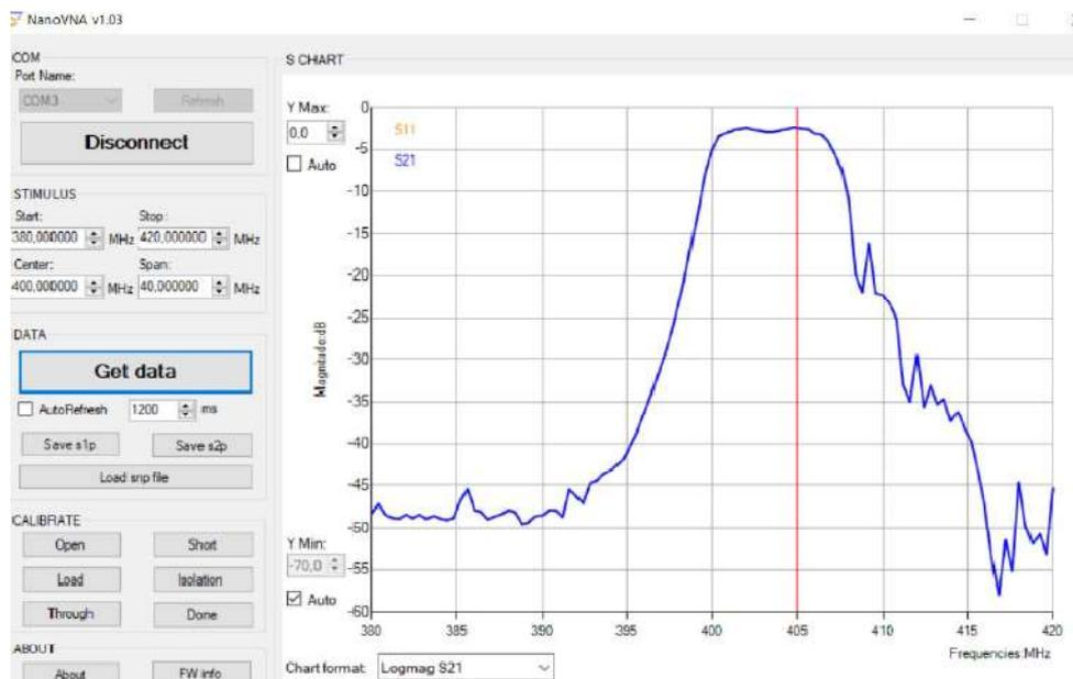
Figure 3 : Course de réponse du filtre pour un balayage de 380 MHz à 420 MHz
