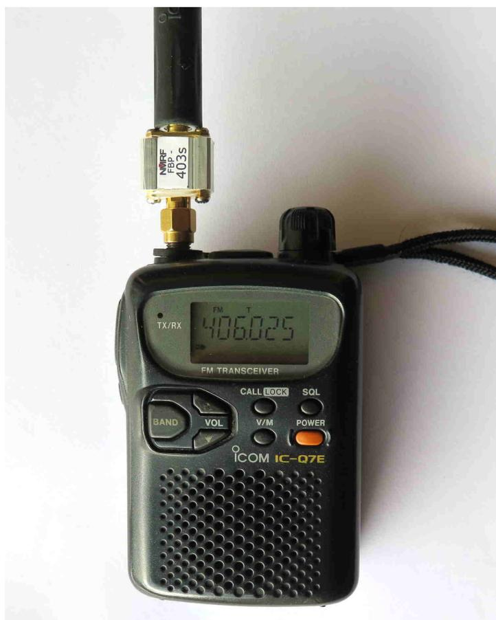
*Photo 1 : Filtre « FBP - 403s » utilisé avec un IC-Q7.
