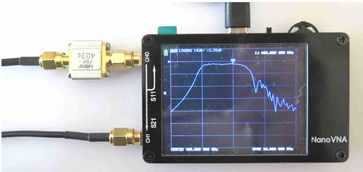
Photo 2 : Test du filtre « FBP - 403s » avec un NanoVNA. Le balayage en fréquence va de 395 MHz à 415 MHz (axe horizontal), avec une fréquence centrale de 405 MHz (marqueur bleu). Sur l'axe vertical, le niveau 0 dB est repéré par le repère bleu.
