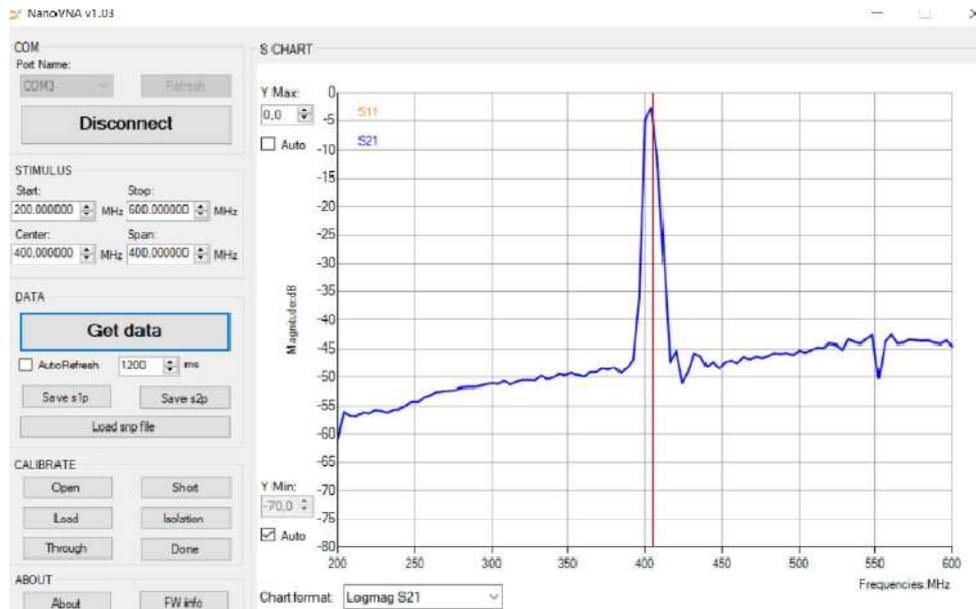
Figure 2 : Course de réponse du filtre pour un balayage de 200 MHz à 600 MHz
