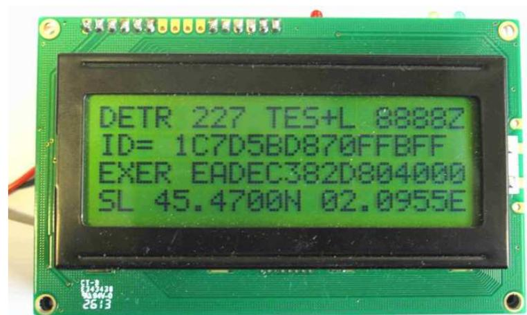
La distance et le cap sont affichés à la place de l'identification (immatriculation ou MMSI par exemple). Pour afficher l'identification, il suffit de déconnecter le GPS du décodeur.
