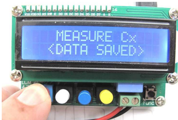
Photo 4 : Initialisation de l'appareil pour la mesure des condensateurs
