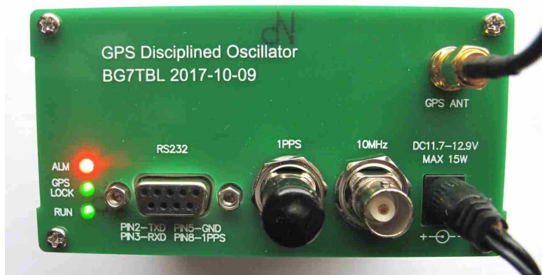
Photo 5 : Le GPS est reçu mais l'oscillateur n'est pas encore calé
