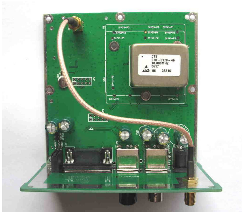
Photo 2 : L'intérieur du GPS Disciplined Oscillator
