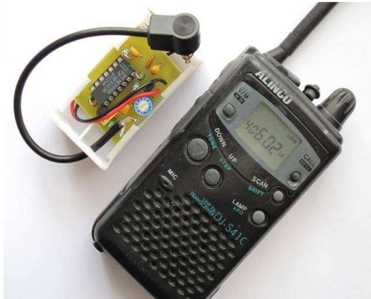
Photo 2 : Emetteur calé sur une fréquence COSPAS SARSAT
