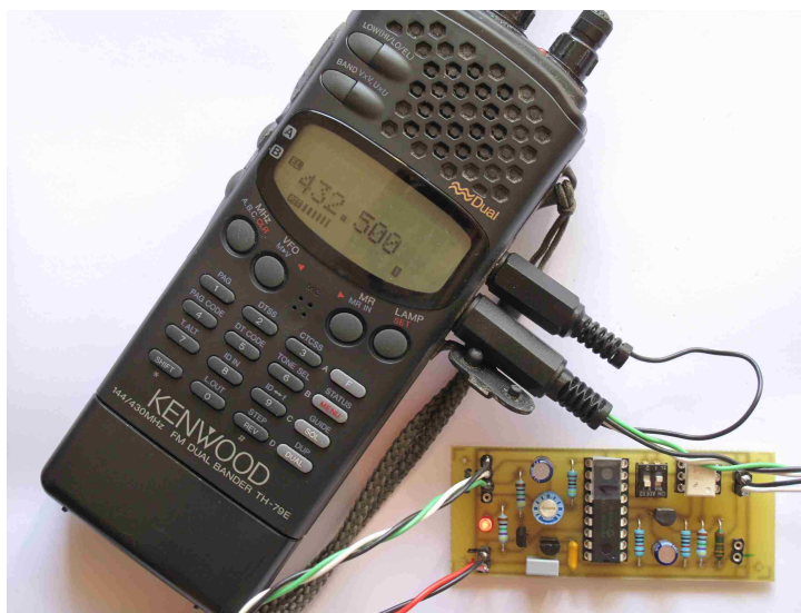
Photo 1 : Balise en 432 MHz avec trames de balise 406. La photo a été prise au moment de l'émission du TH79 : la LED est éclairée, et le bargraph indique la puissance de sortie du TX.
