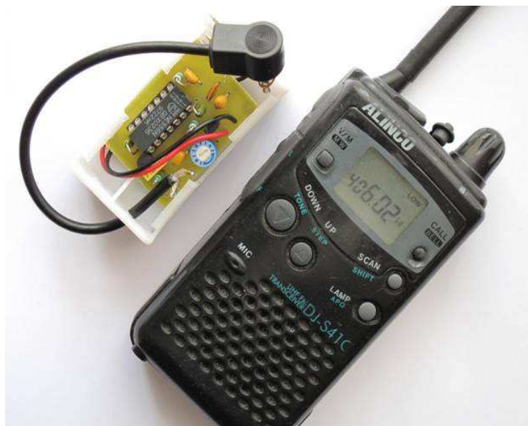
Photo 2 : Emetteur calé sur une fréquence COSPAS SARSAT
