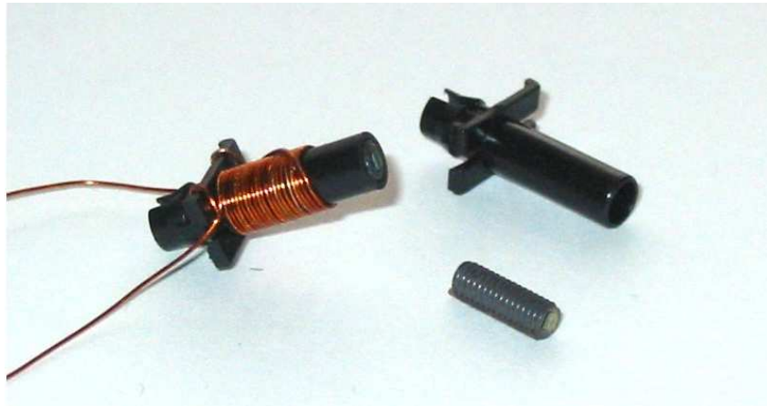
Photo 3 : Réalisation du bobinage de L1
