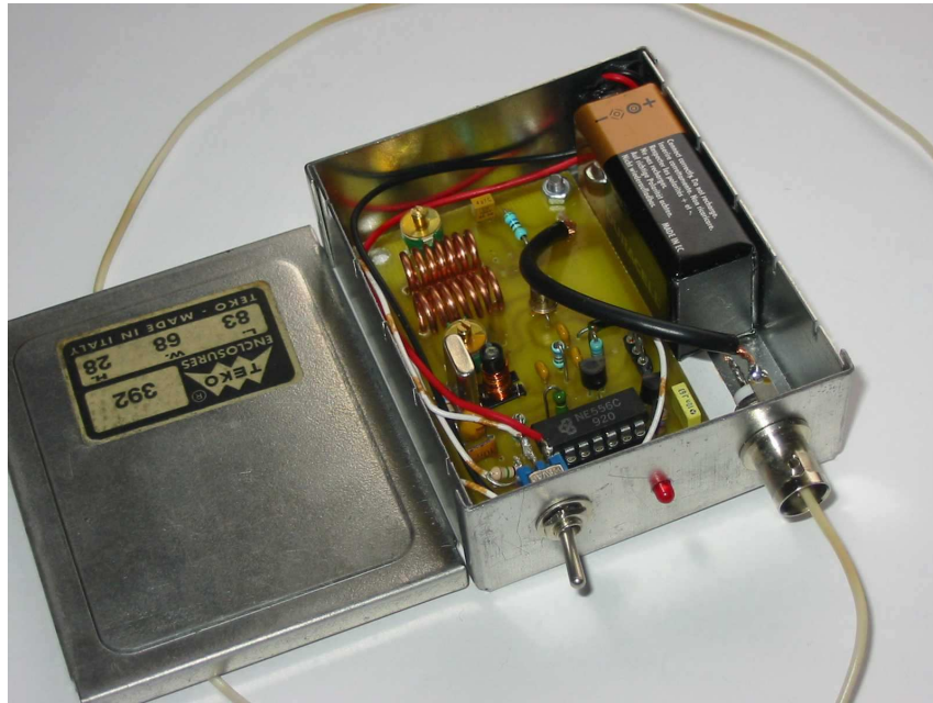
Photo 5 : Utilisation en mini-balise de test de récepteur avec simplement un fil de 60 cm dans la prise BNC
