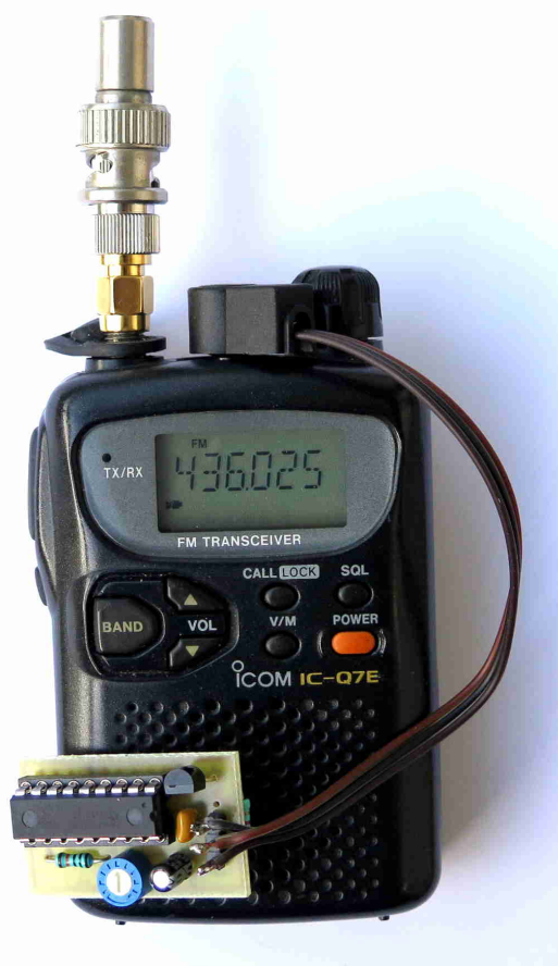
Photo 1 : IC-Q7 en « Balise UHF de test 406 ». Attention à bien respecter les bandes de fréquence autorisées.
