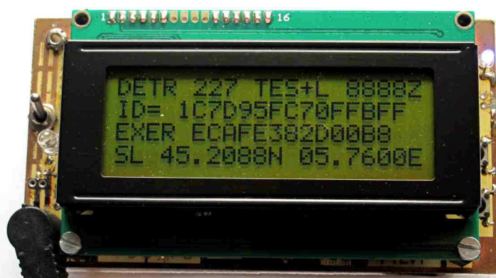
Photo 10 : Décodage de la trame transmise par la balise « Quart de Watt », avec le GPS connecté [4]
