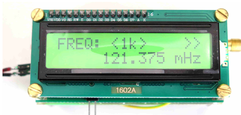
Photo 4 : Le générateur démarre automatiquement sur la fréquence programmée, ici 121,375 MHz (et non mHz)
