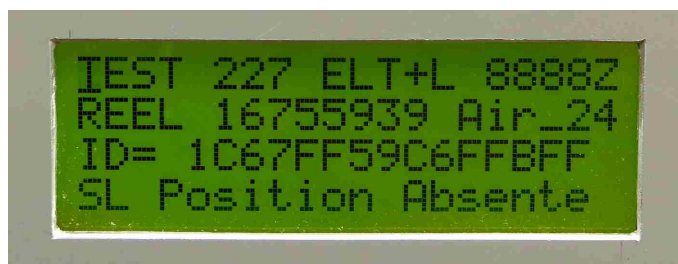
Photo 3 : Décodage des signaux envoyés par le Simulateur de Balise 406 avec la temporisation à 50 secondes entre 2 trames : pas de position préenregistrée
