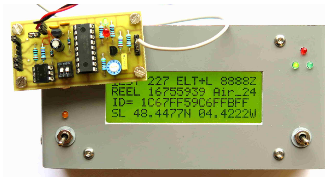
Photo 1 : Décodage des signaux envoyés par le « Simulateur de Balise 406 ». La première position préenregistrée apparaît sur la quatrième ligne de l'afficheur
