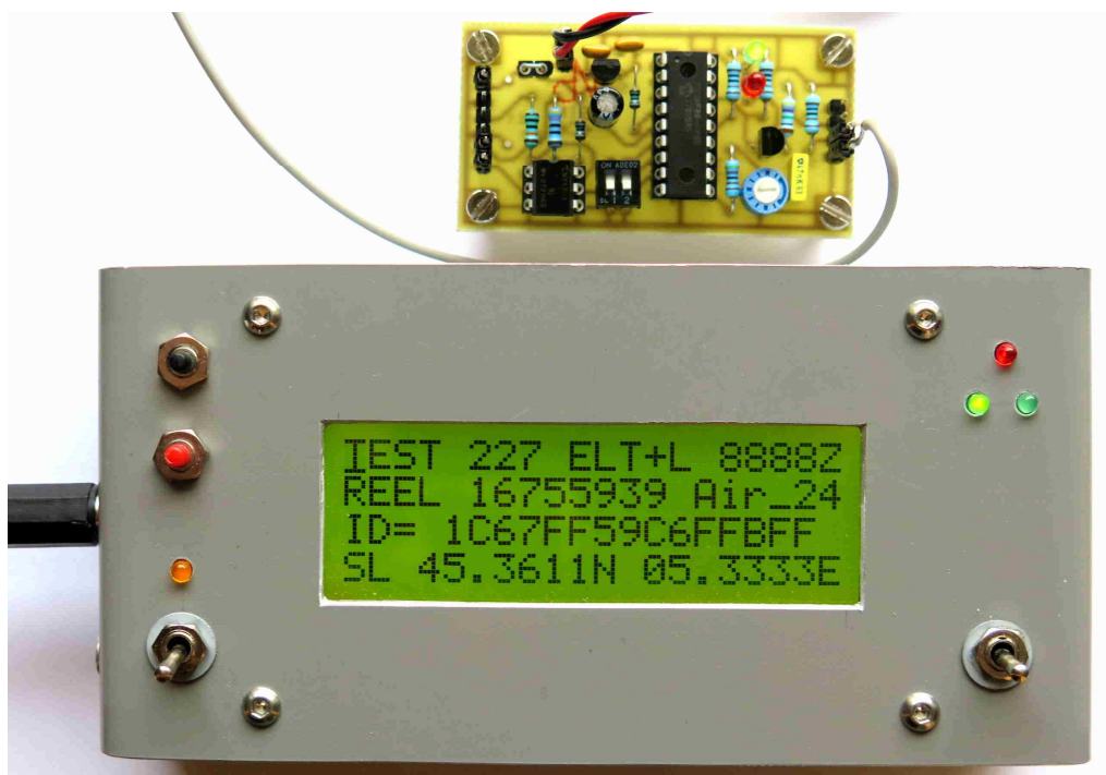
Photo 2 : Décodage des signaux envoyés par le Simulateur de Balise 406 montrant la seconde position préenregistrée
