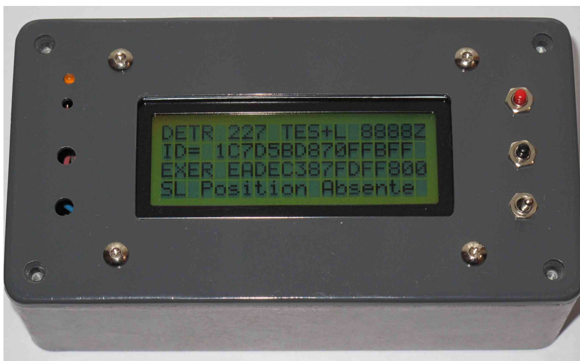
Photo E1 : Décodeur 4 lignes en cours de construction par F1AVR. Test sur une balise d'exercice
