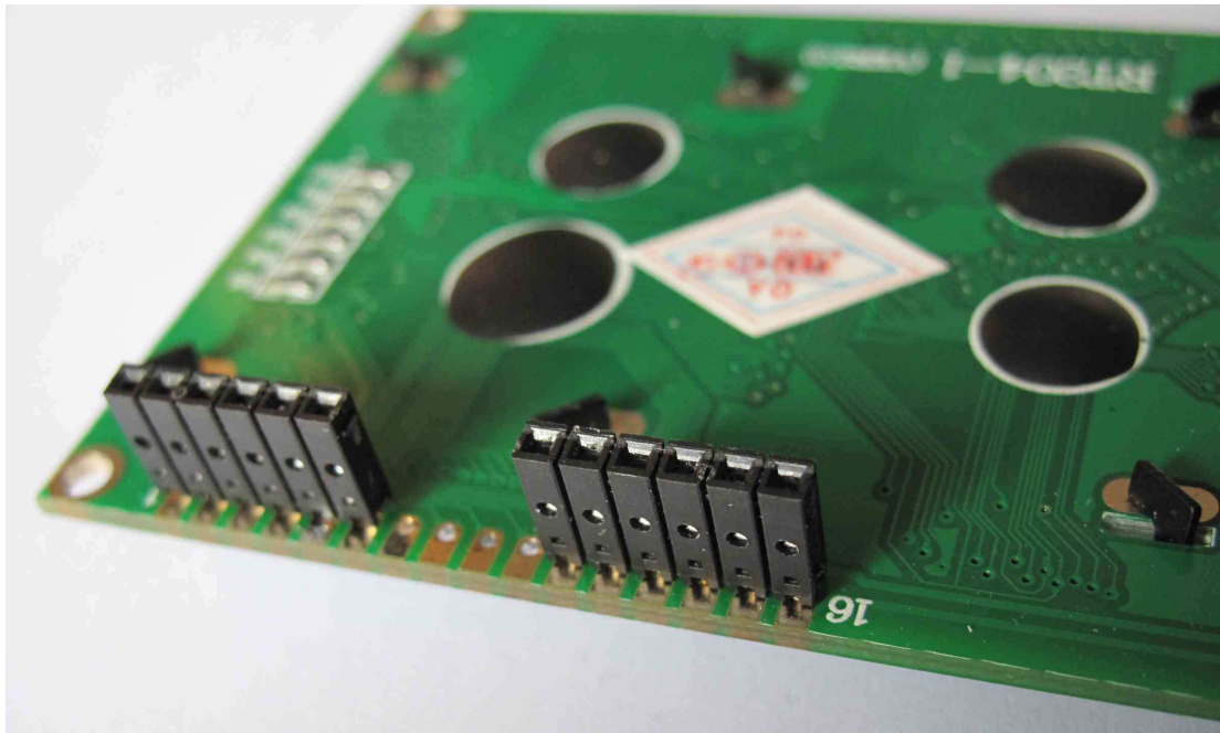
Photo 4 : Les 2 connecteurs femelles 6 broches soudés sous l'afficheur
