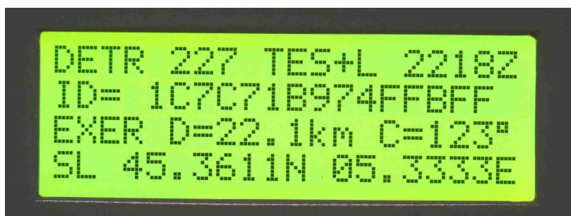
Photo 4 : Affichage de l'heure du décodage (première ligne), de la distance et du cap (troisième ligne)
