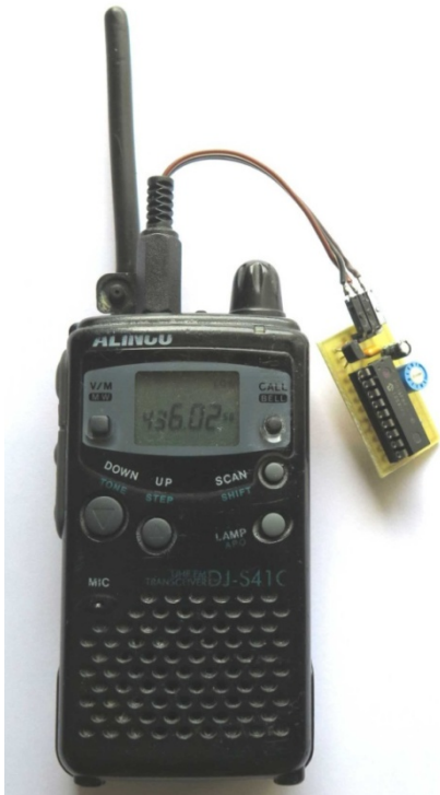
Photo 6 : L'ALINCO DJ-S41T monté en émetteur de trames de balise 406
