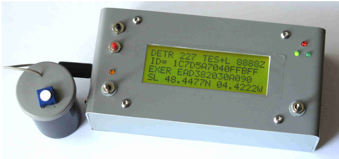
Photo 5 : Décodeur de trames 406 avec le « Testeur de décodeur » qui lui envoie une trame préenregistrée [3].
