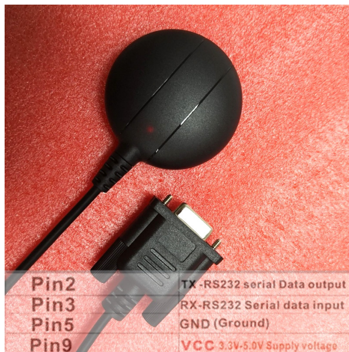
Photo 4 : GNSS multi-constellations 4800 bauds avec sortie RS232. Ce GNSS fonctionne remarquablement bien
