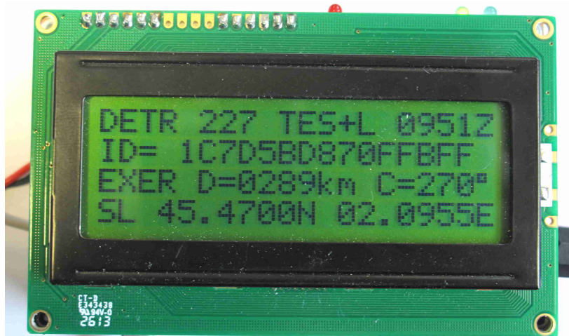
Photo 3 : Affichage de l'heure de réception, de la distance et du cap, en connectant un GPS sur le décodeur DECTRA
