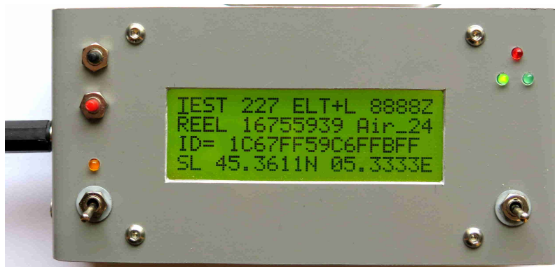
Photo 1 : Décodeur DECTRA construit par l'ADRASEC 38 / F1AVR, avec ses 2 LED vertes : il faut qu'elles soient allumées toutes les 2 pour pouvoir décoder.
