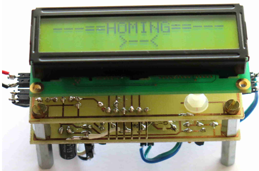
Photo 1 : Homing à afficheur LCD à la place du galvanomètre à zéro central
