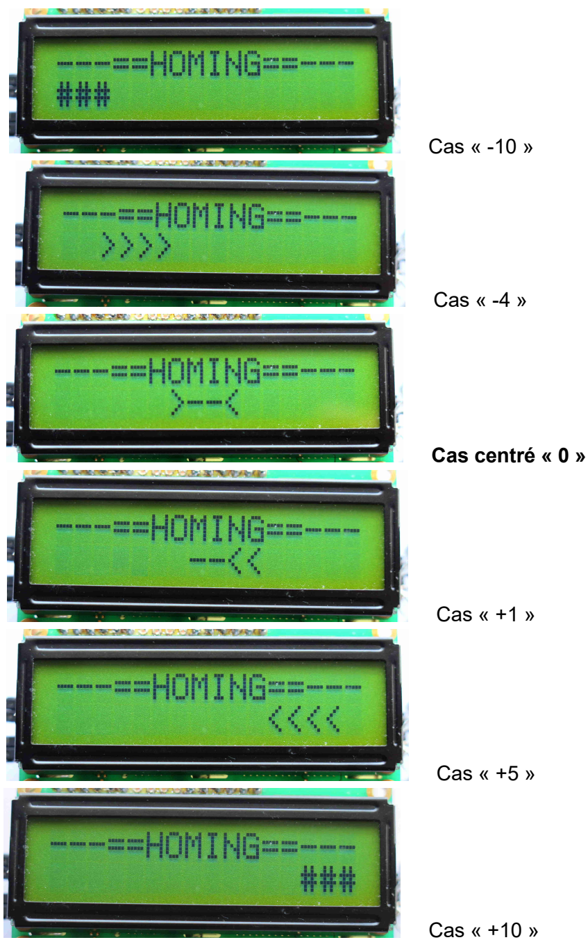
Photo 5 : Indication de la direction Les 2 cas extrêmes « +10 » et « -10 » sont les positions de déviation maximale. Les 4 autres cas présentent quelques unes des positions intermédiaires. La position « Cas centré » est la position recherchée qui donne la direction.
