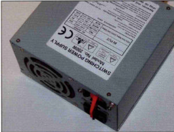
Photo 9: Un interrupteur marche arrêt a été monté à la place de la sortie 220 V inutilisée.
