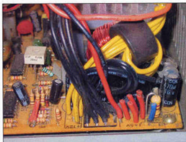
Photo 6: Les fils rouges (5 V) sont tous coupés, sauf un. Ce dernier va à la résistance de 5 ohms. Le fil bleu (-12 V) est également coupé. Les fils jaunes (12 V) forment une boucle en passant au travers d'un tore ferrite pour filtrer la sortie.
