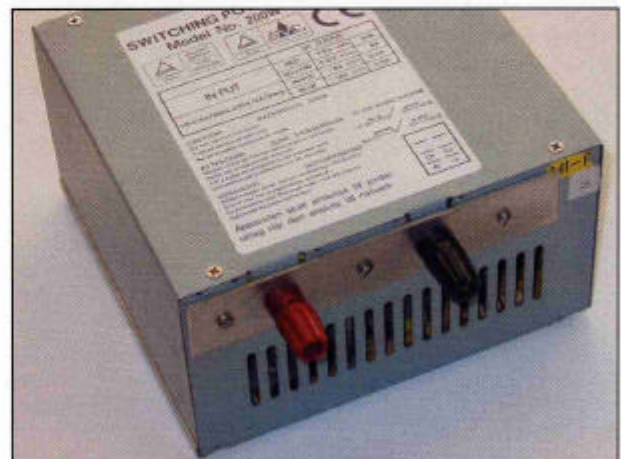
Photo 10: L'alimentation est maintenant finie. Les deux bornes de sortie ont été montées sur une plaque ajoutée qui masque les trous de sortie des nappes de fils, et qui rigidifie l'ensemble.
