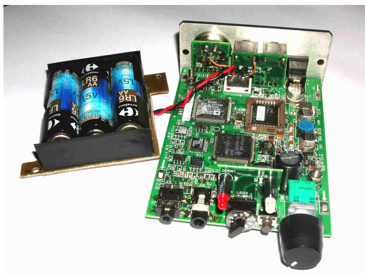
Photo 3 : L'ARD 9000 ouvert avec le porte-pile réalisé, prêt à être monté. Le connecteur 4,5V est situé sur le circuit imprimé près de la prise micro, vers l'arrière de l'appareil.
