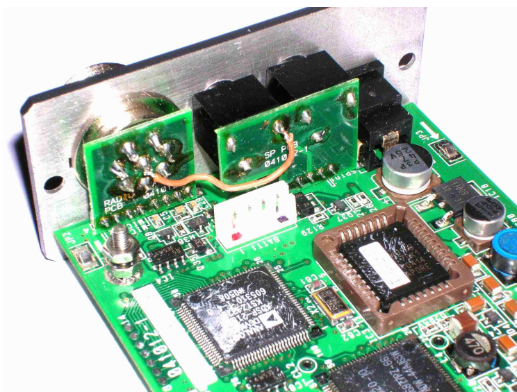
Photo 6 : Le fil orange ajouté permet de relier la broche centrale de la prise micro 8 broches à l'arrivée du signal sur l'entrée jack 3,5 « SP IN ».
