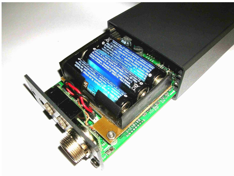
Photo 5 : Le volume disponible intérieur est très réduit, ce qui fait que le système porte- piles doit être calculé et réalisé avec beaucoup de soins, mais il entre parfaitement dans le boîtier.
